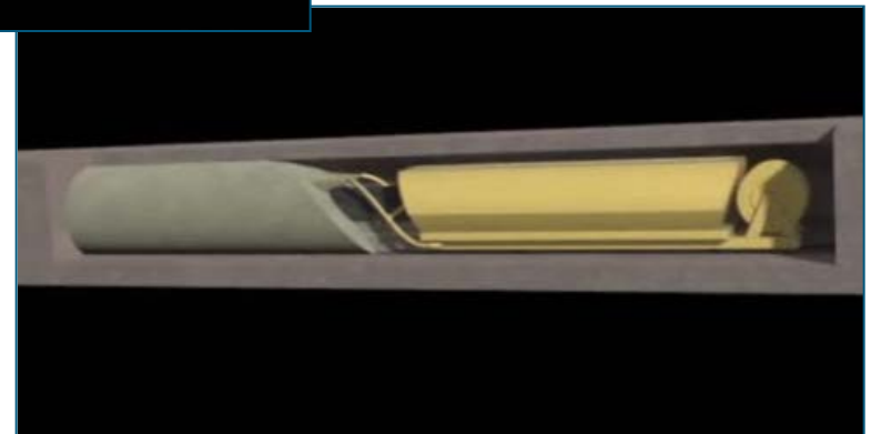
Verfüllung Lagerstollen mit Bentonit-Granulat
