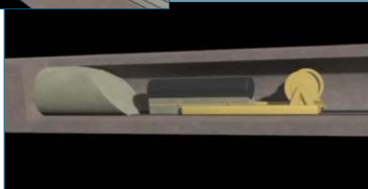
Platzierung Lagerbehälter und Bentonit-Auflager im Stollen
